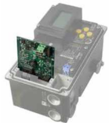
Установка дополнительной платы
